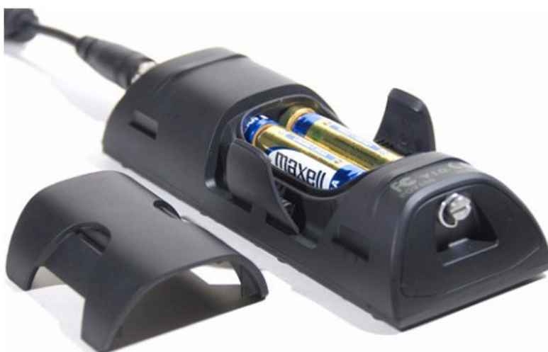
Задняя часть POV.1.5 со снятой крышкой батарейного отсека
